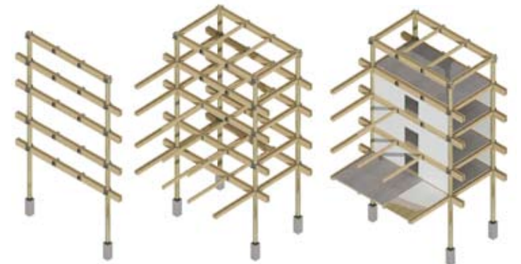
PRINCIPE DE CONTREVENTEMENT PAR VOILE TRAVAILLANT
